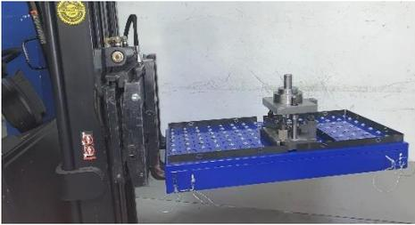
Der SUTTY ist ein universelles Transportsystem für den innerbetrieblichen Transport um z.B. Rüstvorgänge an Spritzguss- oder auch Stanzmaschinen zu optimieren. Er kann per Stapler, Hubwagen oder auch elektr. Ameise genutzt werden und ist modular aufgebaut.
